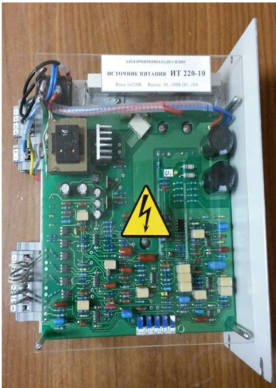
*Источник питания ИТ-220-10 предназначен для питания постоянным током различных нагрузок, имеющих активно-индуктивный характер, например, катушек электромеханических тормозов, соленоидов, обмоток возбуждения электрических машин и т.п.*
